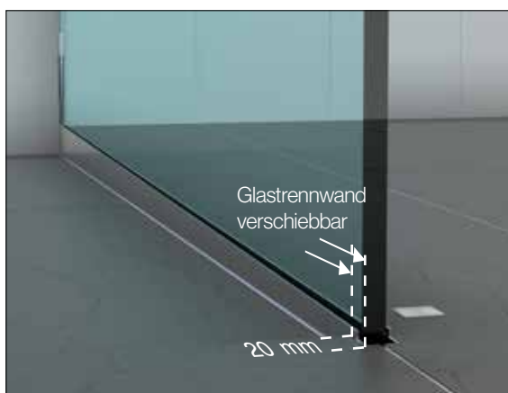
Nach Einbau hat die Bodenschiene eine Toleranz von 20 mm für die Montage der Glastrennwand. So können eventuelle Wand- oder Boden-Ungenauigkeiten problemlos ausgeglichen werden.
