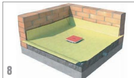
8. Entsprechend der benötigten Höhe wird das Aufsatzstück gekürzt und am unteren Ende ein Dichtring befestigt. Danach das Aufsatzstück auf dem Spannring montieren, der bereits auf dem Grundkörper verschraubt ist.
