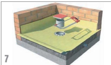
7. Mit dem zum Bodenablauf gehörenden Aufsatzstück können Höhenunterschiede von 10 bis 90 mm ausgeglichen werden. Das Aufsatzstück sollte beim Verfliesen mit der Abdeckplatte geschützt werden.
