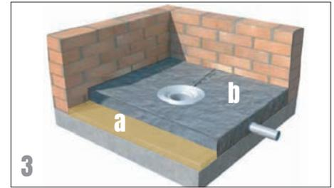
3. a. Ergänzen Sie Tritt- und Wärmedämmung in der Duschfläche.
