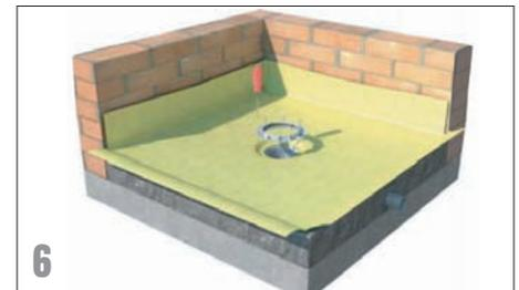
6. Montieren Sie den Spannring mit den 6 beiliegenden Schrauben. Um die Montage zu vereinfachen, richten Sie die Schraubenlöcher entsprechend der Markierung am Grundkörper aus.
