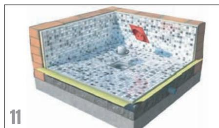
11. Entfernen der Abdeckplatte. Montieren Sie den Geruchsverschluss, der zur Reinigung wieder entfernt werden kann.
