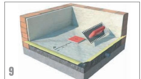
9. Jetzt Dünnbettmörtel (Fliesenkleber) auf die Abdichtungsfolie mit der gewünschten Aufbaustärke einbringen.
