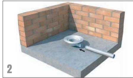
2. Setzen Sie den Ablaufkörper (optional Montagering für die perfekte Halterung und Schallschutz-Set). Schliessen Sie den Ablaufkörper an die Abflussleitung und prüfen Sie die Verbindung auf Dichtigkeit.
