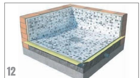
12. Setzen Sie zum Schluss den noch fehlenden Edelstahlrost in den Rahmen.
