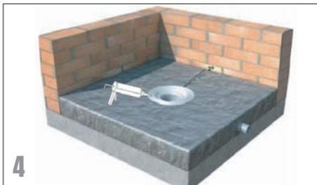
4. Montagekleber auf den Grundkörper des Ablaufes aufgetragen bevor die Abdichtungsfolie/bahn montiert wird. Schützen Sie dabei den Innenbereich des Ablaufs vor Verschmutzungen.
