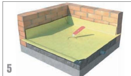
5. Installieren Sie jetzt die Abdichtungsfolie auf dem Estrich. Wir empfehlen eine Geotextil- oder PVC-Abdichtungsfolie, die auch an den Wänden (Dusche) hochgezogen werden muss.
