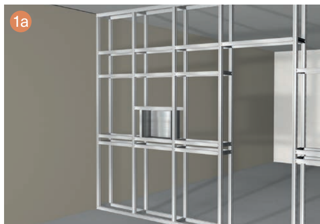
Die IN-BOX ADATTO in eine Holz- oder Trägerkonstruktion einpassen.
