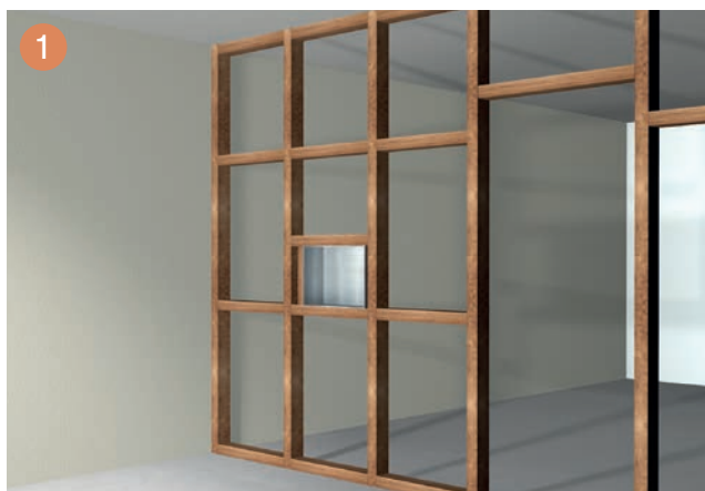
Die IN-BOX ADATTO in eine Holz- oder Trägerkonstruktion einpassen.
