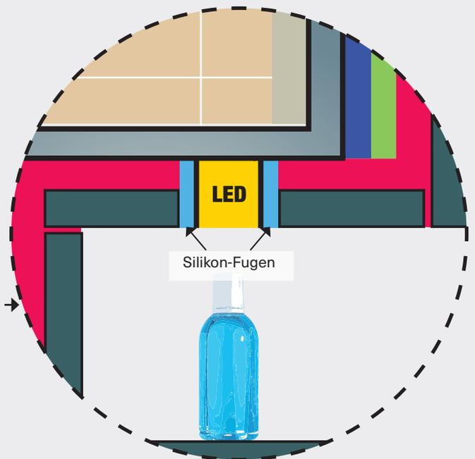
Die IN-BOX LUNA wird absolut wasserdicht ins Mauerwerk oder eine Vorwandinstallation eingebaut und der Flansch mit herkömmlichen Materialien abgedichtet (z. B. Verbundabdichtung).
