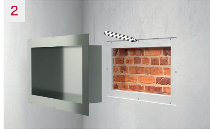
2 Anzeichnen und Bohren der Schraubenlöcher (Bohrungen, Ø 6 mm)
