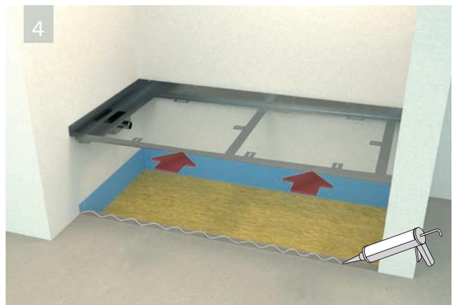
a. Das Elemento Due Flex millimetergenau in die Nische einpassen.
