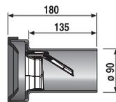
**WC-Anschlussset DN 90, mit rat blocker (Rattensperre)**
