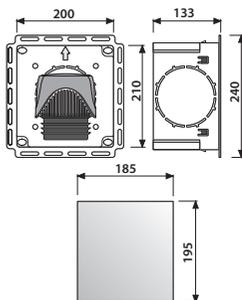
**Wandeinbaukasten zur flächenbündigen Montage, mit Rohrbelüfter ventilair® DN 70 - 100**
