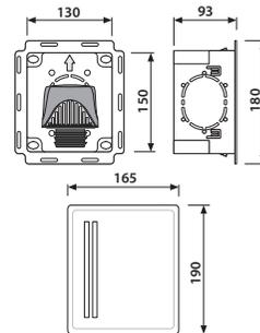
**Wandeinbaukasten mit Rohrbelüfter ventilair® DN 70 - 100**
