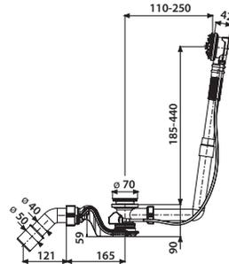
**Bedieneinheit für Funktionseinheit SWING**
