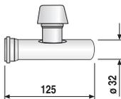
**Verlängerungsrohr mit Muffe für Einzelobjektbelüftung**
