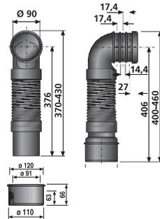
**WC-Anschlussrohr DN 90/DN 100, flexibel, gerade, 3-fach verstellbar**
