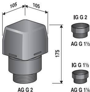
**ventilair® active mit Gewindeanschlüssen**
