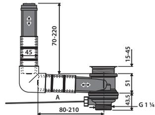
**Push-Open Kartuschenventil für INEO FLUX**
