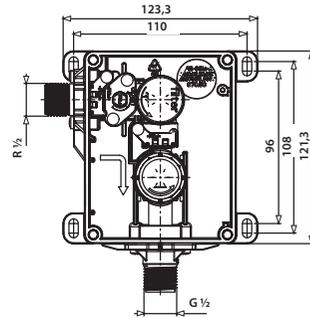
**Abdeckplatte und Leerrohr 1,7 m für Urinal-Rohbaukasten**
