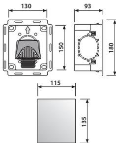
**Wandeinbaukasten zur flächenbündigen Montage, mit Rohrbelüfter ventilair® DN 30 - 50**
